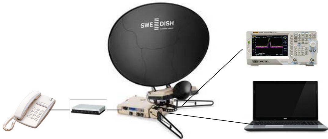
図1 衛星通信装置の構成
