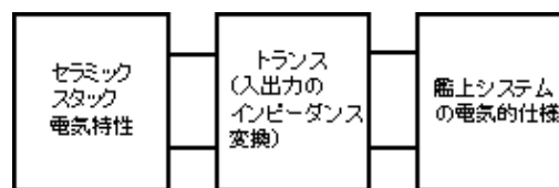
図2 送受波器の電気的特性と艦上システムの電気仕様の整合模式図
